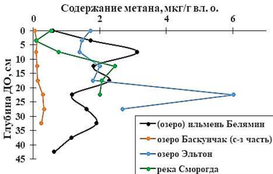
Рис. 3. Вертикальное распределение содержания метана в толще пелоидов исследованных водных объектов / Fig. 3. Vertical distribution of methane content in the thickness of peloids of the studied water bodies
